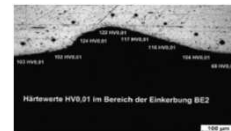
Härtewerte HV0,01 im Bereich der Einkerbung BE2
