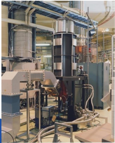
Canon E3774 Klystron 500MHz, 180kW
