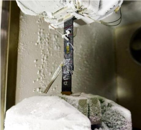
Figura 2 Ensayo a baja temperatura en el que se enfría tanto la probeta como otros componentes del sistema, lo que incrementa significativamente el tiempo de enfriamiento. Imagen tomada dentro de la cámara de ensayo.
